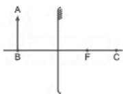
Com base no esquema da figura, assinale a alternativa que representa corretamente o gráfico da imagem do objeto AB, colocado perpendicularmente ao eixo principal de um espelho esférico convexo.
